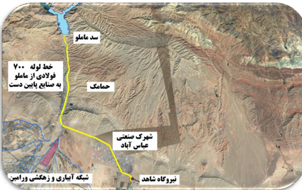
تصویر (۱۳-۱) پروژه تامین و انتقال آب (از سد ماملو به واحدهای صنعتی و خدماتی شرق استان تهران)
