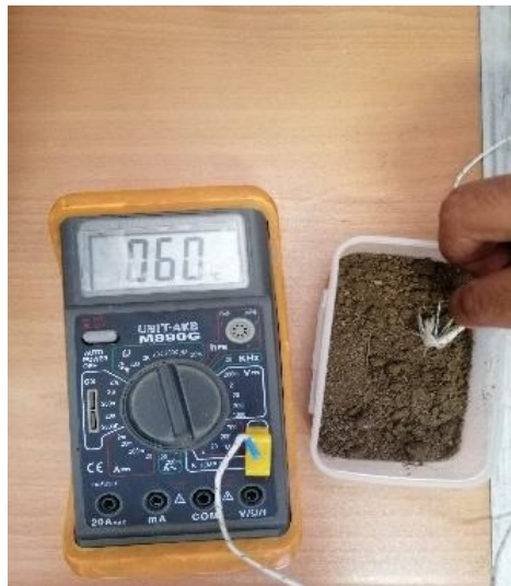
شکل ۳-۲: استفاده از ترموکوپل مولتی متر برای اندازه گیری دمای نمونه ها
