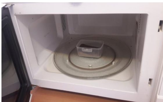
شکل ۲-۴: نمایی از قرار دادن نمونه خاک در اجاق ماکروویو جهت افزایش دما
