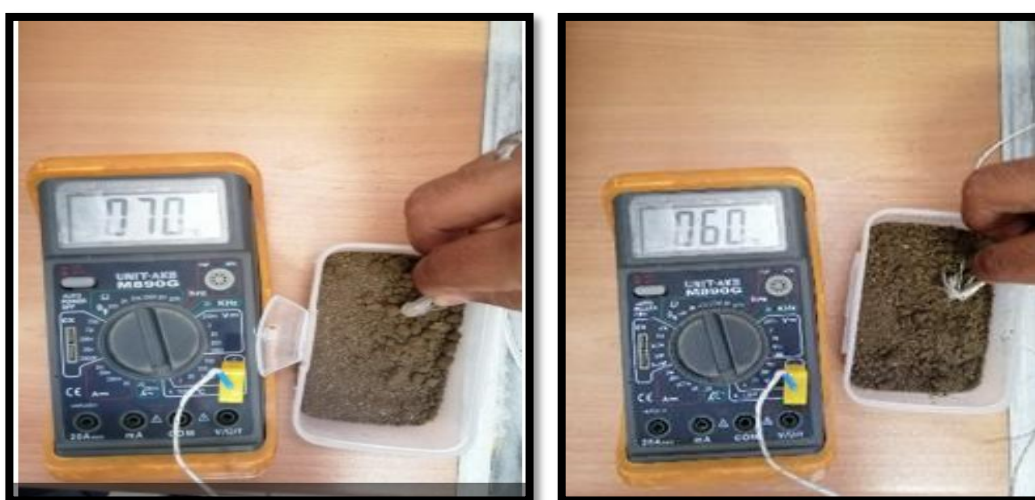
شکل ۲-۵: نمایش مقدار دما پس از قرار دادن در اجاق ماکروویو
